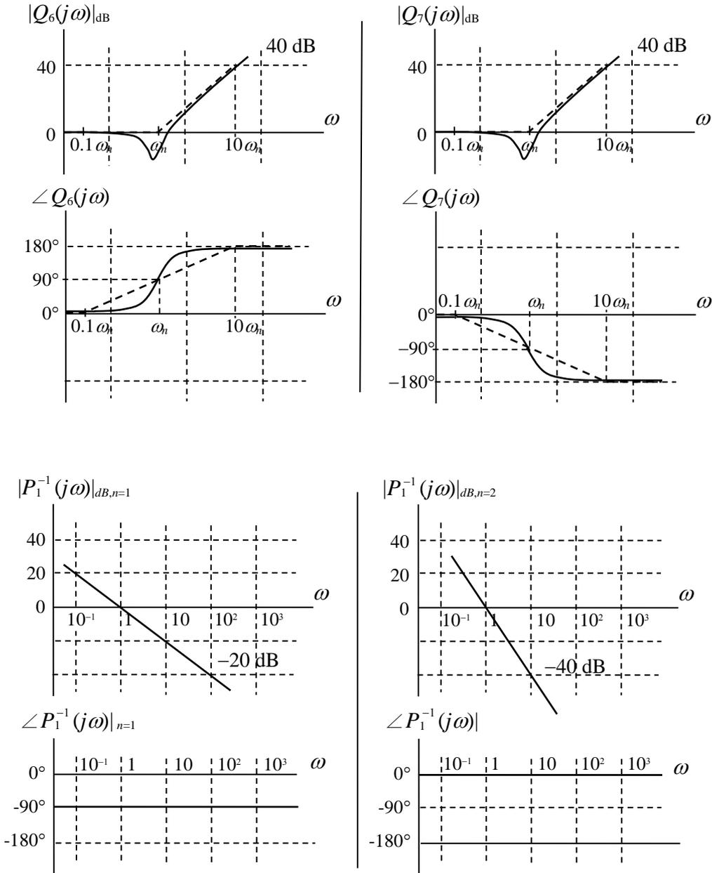
$P(s)$  各基本型式之波德圖  $|P_k^{-1}(j\omega)|_{dB}$  與  $\angle P_k^{-1}(j\omega)$  分析如下所示：
