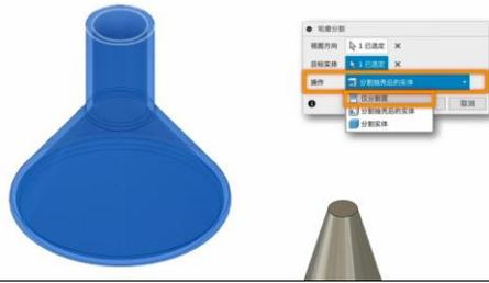
10. 操作選擇分割抽殼後的實體，能將抽殼後的實體分模線方向進行分割。
