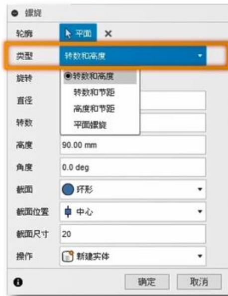
5. 高度欄位是控制「螺旋生長路徑的總高度」，但不包含截面直徑。
