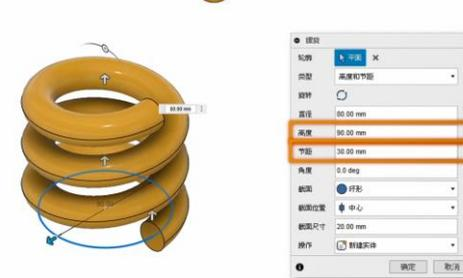
7. 角度欄位類似斜角功能，正值外傾斜，負值則向內傾斜。
