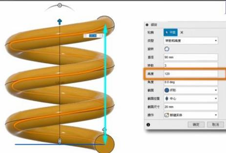
6. 節距代表兩個螺旋線之間間距，正值需與高度欄位相同。
